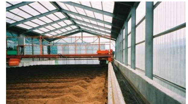
汚水散布写真
